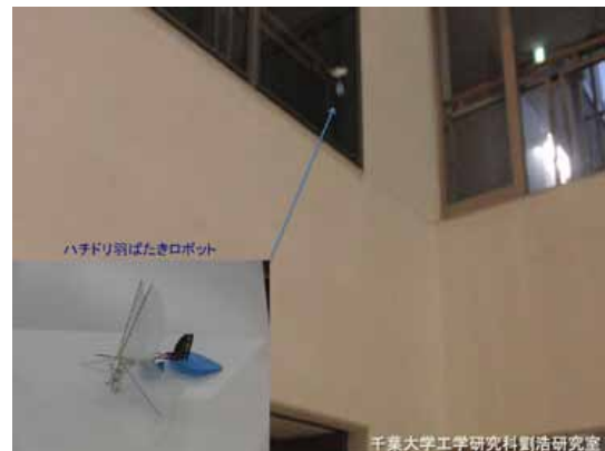
図 13 A hummingbird-inspired, flapping robot (千葉大学、劉浩研究室).
