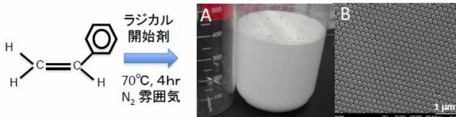
図7 ソープフリー乳化重合によるコロイド粒子の調整： スチレンモノマーが純水中にてラジカル重合反応 A：ポリスチレン懸濁液（90% 以上の高い収率） B：高い単分散性（粒子径：232nm）
