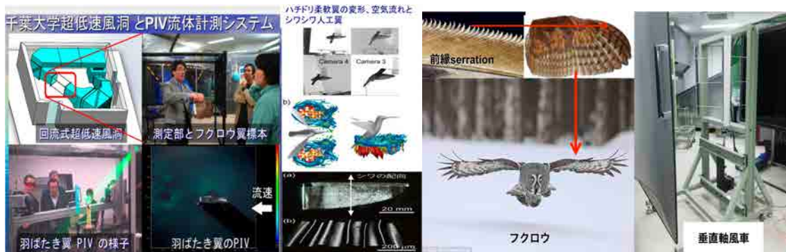
図1 回流型超低速風洞と DPIV 流体計測システム 図2 生物規範流体機械の研究開発
