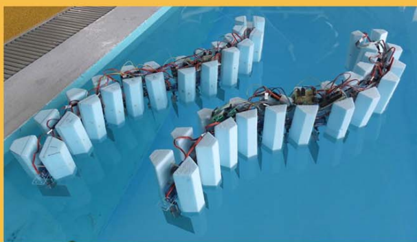
全方向推進が可能な水中ロボット
