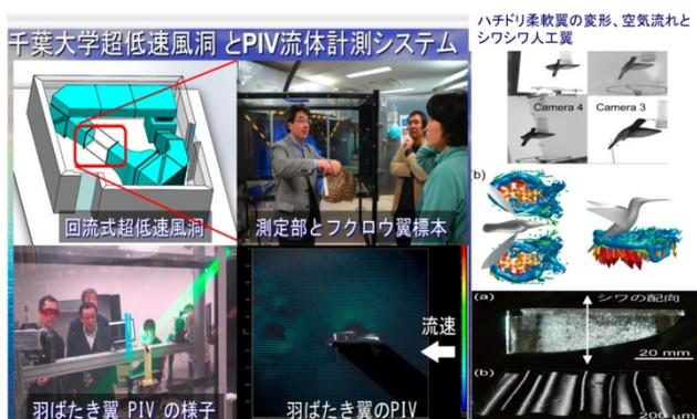
図 1 超低速回流型風洞とステレオ DPIV 流体計測システム
